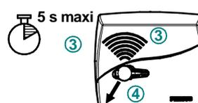
En positionnant le réflecteur devant la cellule, le robinet émet un clignotement lent et bloque l'écoulement. puis émet un clignotement rapide (retirer le réflecteur pendant le clignotement rapide).
