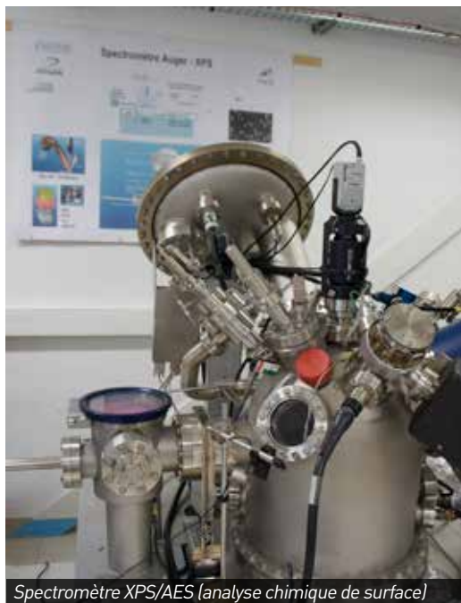
Spectromètre XPS/AES (analyse chimique de surface)
